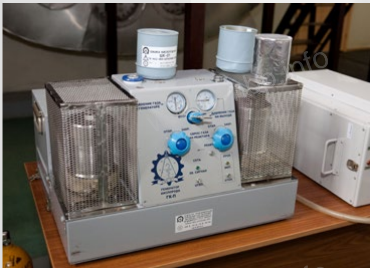
Генератор кислорода ГК-П и кислородная шашка ГК-01 Oxygen generator GK-P and oxygen grain GK-01
