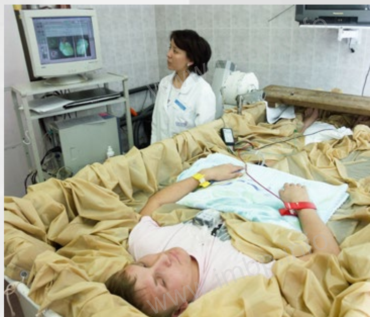
Проведение дисперсионного картирования электрокардиограммы комплексом «Экосан-2007» во время 7-суточной «сухой» иммерсии, 2007 г. Disperse mapping of ECG by "Ecosan-2007 equipment during 7-day "dry" immersion, 2007
